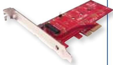
ROLINE PCIe 4.0 x4 3.3V5A Host Adapter für PCIe-NVMe M.2 110mm SSD
